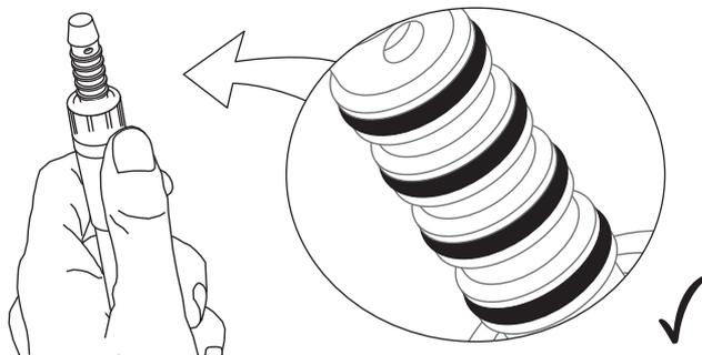
⚠ Este aparato está equipado con un adaptador especial, que corresponde al racor de turbina existente en su unidad dental. Utilice el aparato únicamente con su racor de turbina específico. Conectarlo con otro racor de turbina podría dañarlo.
