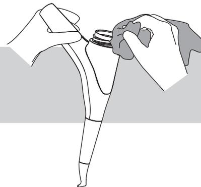
Am Ende eines jeden Arbeitstags die Pulverkammer reinigen.
