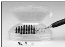
Den richtigen Aufsatz anhand der unten beschriebenen Farbcodierung auswählen: Anthrazit: Kugel; Türkis: Chisel; Violett: Spitze
